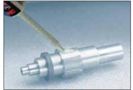
*Kleben eines Magneten an einen Stahlrotor
